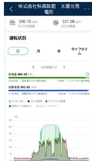
▲太陽光発電と電力消費状況
